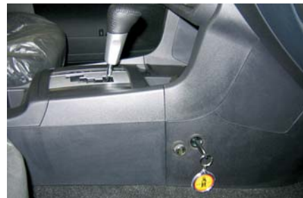
▲ Замок CVT (вариатор) штыревой RSA-MIT-1166
