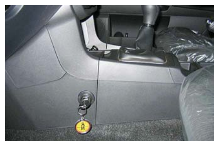
▲ Замок МКПП бесштыревой поворотно-нажимного типа RSA-MIT-1173K
